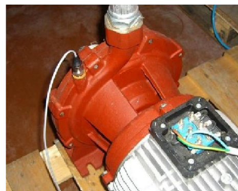
Obr. 4: Príklad montáže snímača do plniaceho otvoru čerpadla
