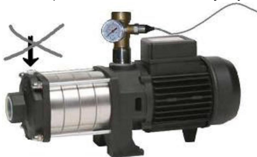
Obr. 5: viacstupňové čerpadlo - otvor pre manometer použiť pre snímač
