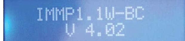
3. Spustíme samoregulačný test stlačením tlačidla START. Čerpadlo sa ešte nespustí, ale na displeji sa objaví nastavovacie menu základných parametrov motora:
