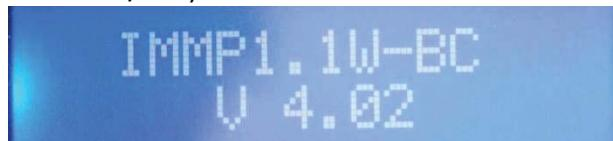
3. Spustíme samoregulačný test stlačením tlačidla START. Čerpadlo sa ešte nespustí, ale na displeji sa objaví nastavovacie menu základných parametrov motora:
