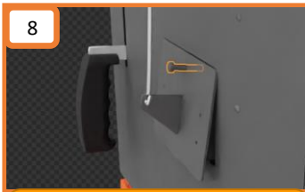
Minimální otevření primární klapky - klapka nesmí být nikdy úplně zavřena
